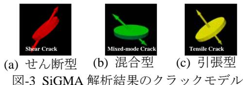
図-3 SiGMA 解析結果のクラックモデル
