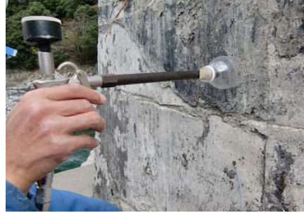
図-3 打ち継ぎ部試験状況
