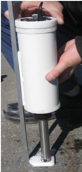
写真 3 スティックスキャナーによる撮影状況
