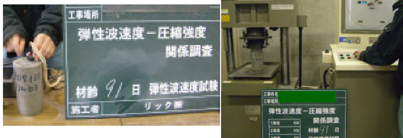
写真1 弾性波速度と圧縮強度の関係調査状況
