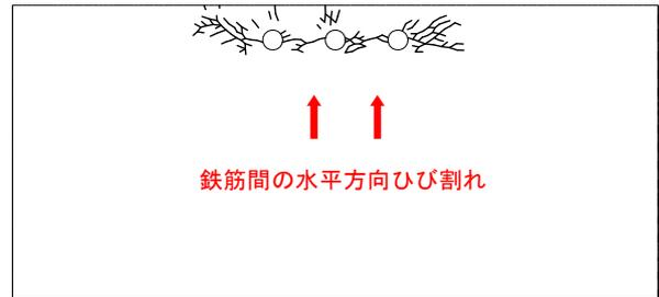
図-4 解析結果 (D16,  $t_p=20\text{mm}$ , 鉄筋間隔 50mm)
