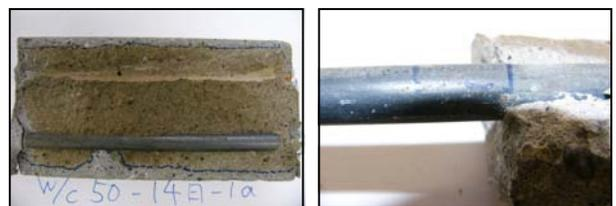
写真-3 W/C50%供試体 (腐食確認)
