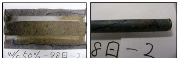
写真-4 W/C50%供試体 (行き過ぎ部で腐食)
