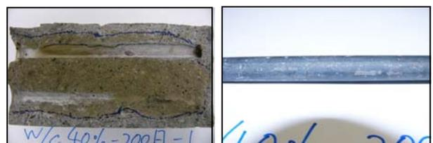
写真-5 W/C40%供試体 (達する前に腐食)
