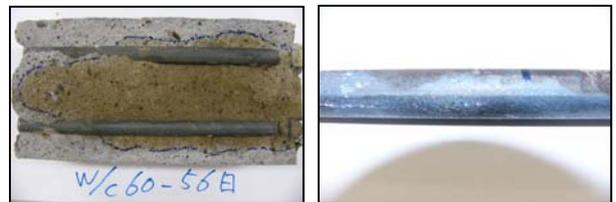
写真-2 W/C60%供試体 (行き過ぎ部で腐食)
