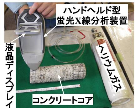
写真-1 ハンドヘルド型蛍光 X 線分析装置によるコア側面の測定
