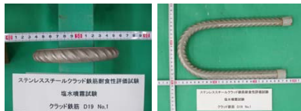
A) 曲げ加工部 B) 曲げ加工部以外 写真-2 塩水噴霧試験の後の鉄筋写真
