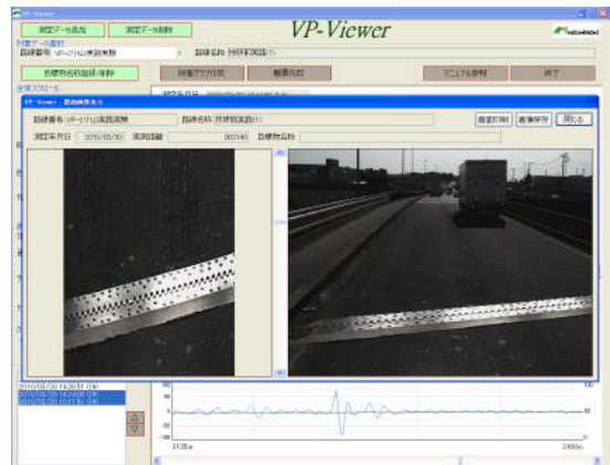
図-7 橋梁ジョイント部の段差測定例
