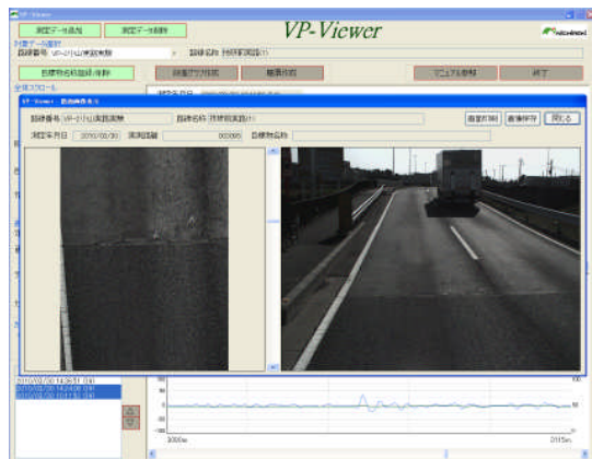
図-4 構造物前後の縦断勾配の不良例
