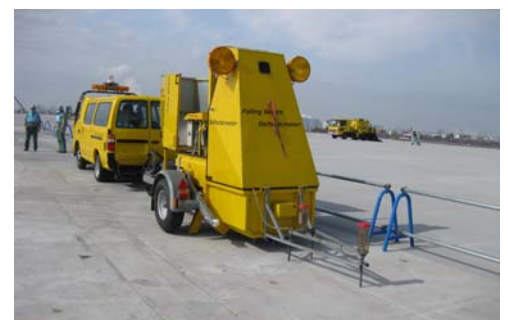
写真-1 空港舗装対応 FWD 試験機
