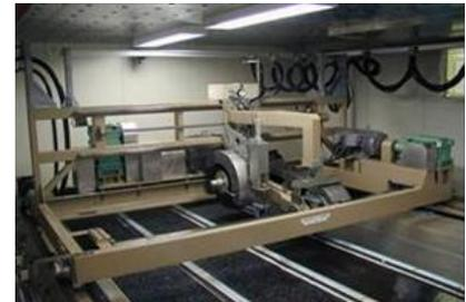
写真-1 室内凍結路面走行試験装置
