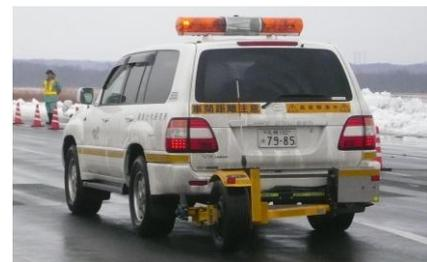
写真-3 連続すべり摩擦抵抗測定装置 (CFT)
