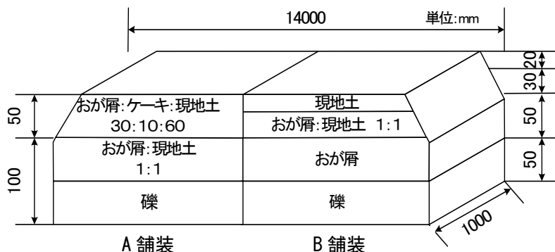
図-1 ウォーキング歩道の舗装構造
