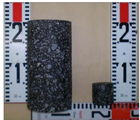
写真-1 \phi 100 \cdot h200 と \phi 50 \cdot h50 の供試体
