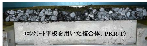
写真-1 WT 疲労試験後供試体
