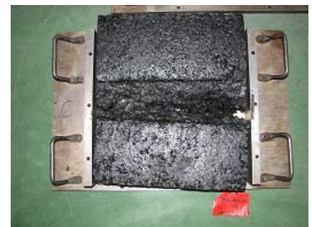
写真-1 WT 疲労試験後供試体
