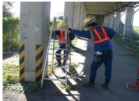
図-1 柱下部打撃手法の風景
