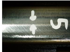
写真-1 レール頭面削正状況 (5パス後)
