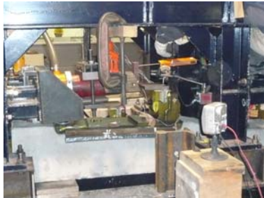
写真－3 単体載荷試験（絶縁材入）
