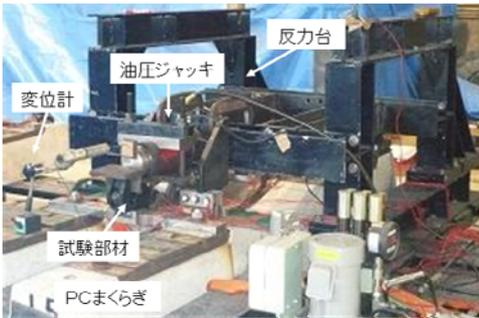
写真-1 水平載荷試験の実施状況
