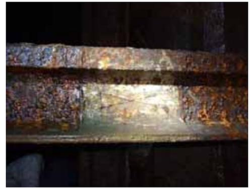
写真4 テストピース（暴露後）
