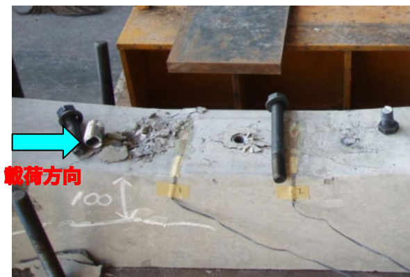
図3 ボルト破断による破壊形態 (3H: アンカー深さ 90 mm の例)
