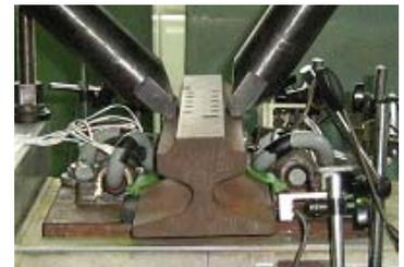
図 1 斜角載荷試験 (PR447)
