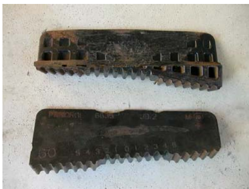
写真 1 楔形インシュレーターの摩滅
