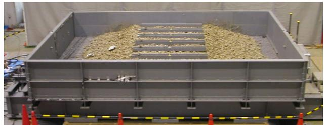
写真-1 振動台試験装置と試験体
