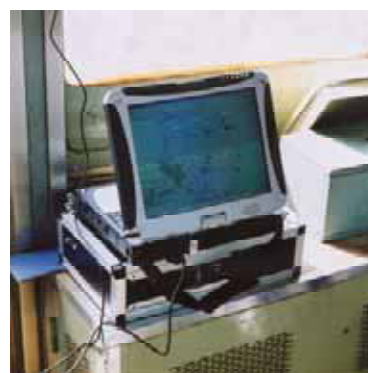
図 4 車両へのプローブシステムの設置状況
