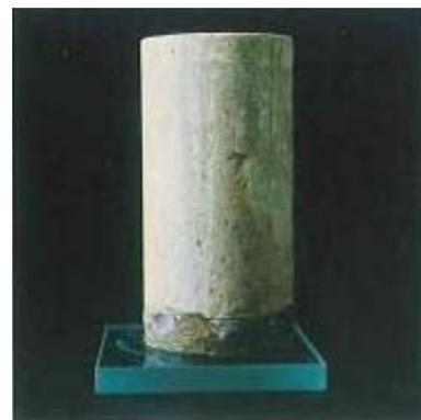
写真1 マスキングシリカが形成され16年間経過したモルタル供試体<sup>5), 6)</sup>
