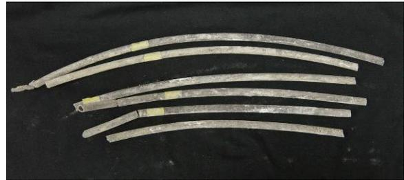
写真4 一年埋設後に回収したバイオチューブ
