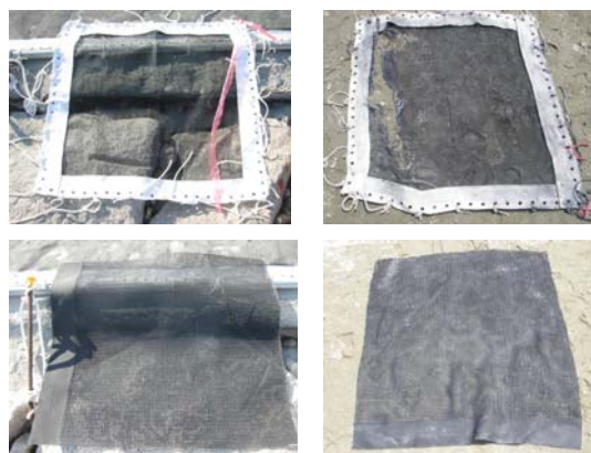
写真-2 上段:30kN/m, 左側:設置時, 右側:5年後 下段:100kN/m, 左側:設置時, 右側:5年後
