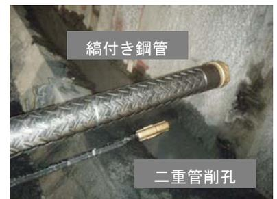
写真-3 削孔ツール
