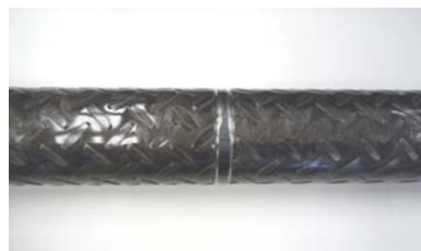
写真-1 縞付き鋼管の 表面形状
