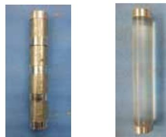
図-2 円筒管模型 図-3 杭型模型
