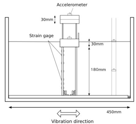
図2 振動台実験模式図
