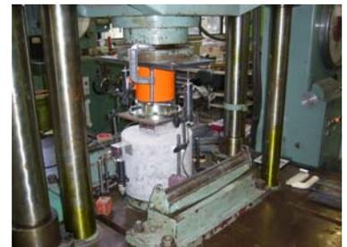
図3 付着試験状況
