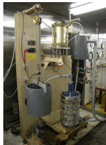
写真-5 透水試験状況
