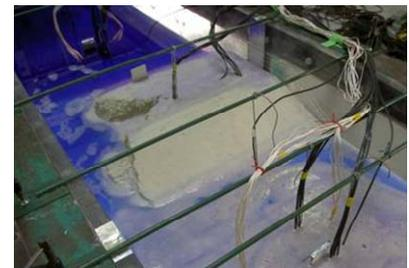
写真2 越水による破堤(ケース1)
