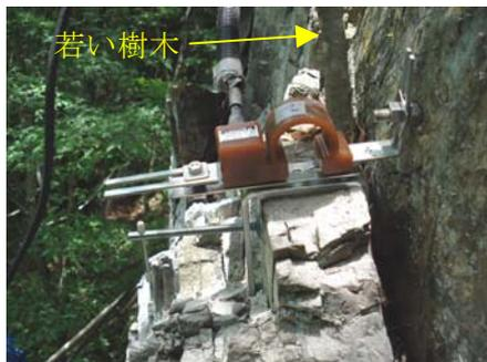
図2 樹木進入部に設置した亀裂変位計 No.4
