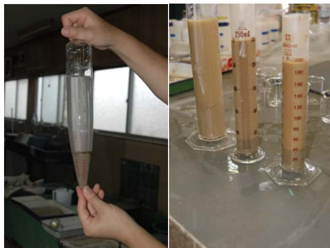
写真-1 砂分測定 写真-2 シリンダー測定
