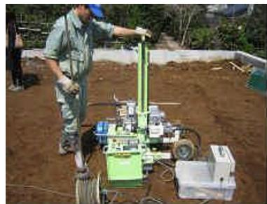
写真 1 SDS 試験装置
