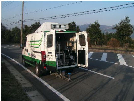
写真-3 FWD 測定車 (測定時外観)
