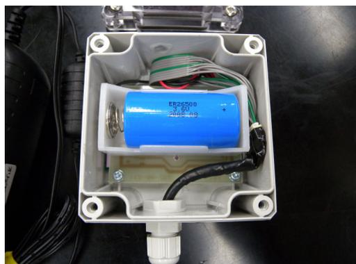
図2 HMB 加速度センサ IC タグ
