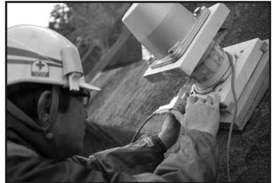
Mリング計測器による測定状況
