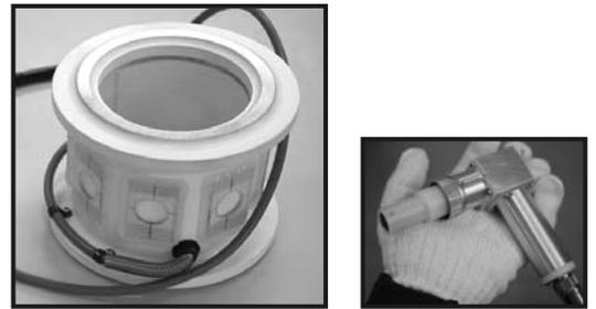
Mリングセンサーと計測プローブ
