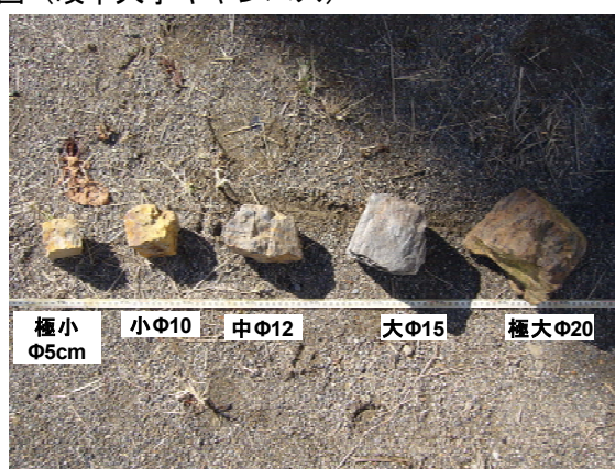
図2 石の鉛直落下に用いた石
