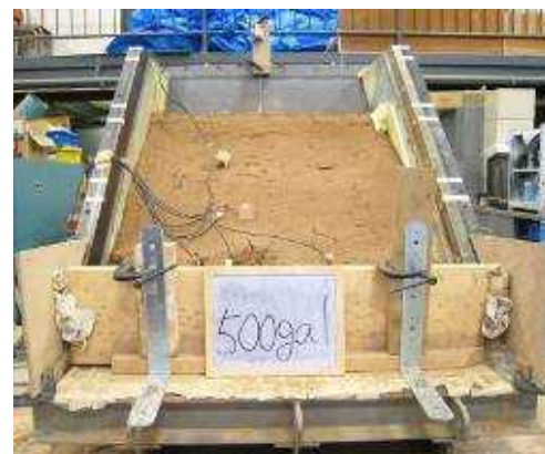
写真 1 崩壊後の地盤の様子
