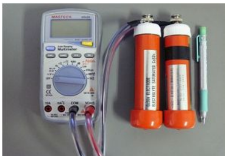
写真一2 自然電位法の測定機器
