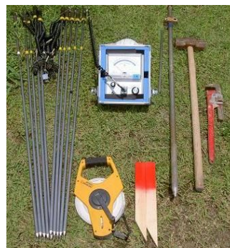
写真—1 1m 深地温探査の測定機器
