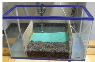
写真一3 浸透流速と流動電位の相関性検討水路
