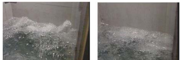
写真1 垂壁先端形状の対策効果
