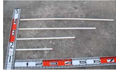
写真-3.1 全長 8m,13m, 18m,23m を組み合わせた樹脂製の丸棒
