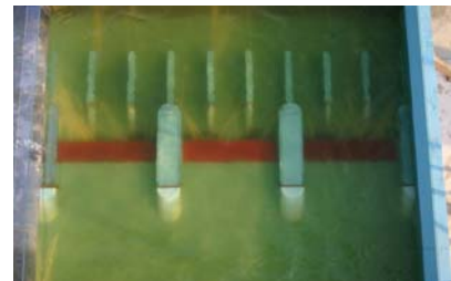
写真-3.2 傾斜化の効果 4400\text{m}^3/\text{s} における流木の捕捉状況 上段は傾斜なし、下段は傾斜あり
