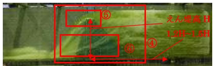
写真2 側壁から見たスリット部とその周辺の流況
