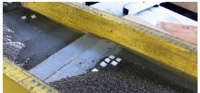
Fig. 4 上流護床工の流亡状況 (小タイルを配置した堰③, 0.8L/sの実験)
