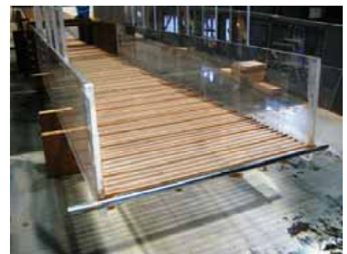
図-2 棧粗度を設置した実験開水路
