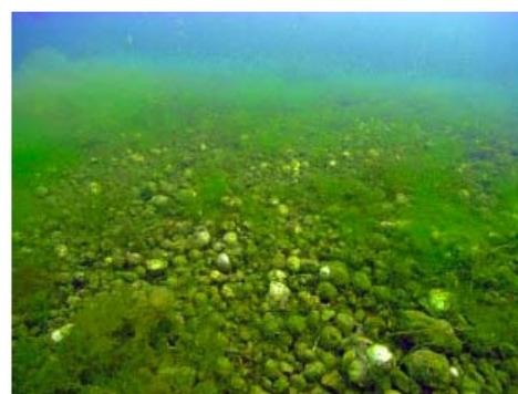
写真-1 石炭灰造粒物覆砂状況(3年経過)
